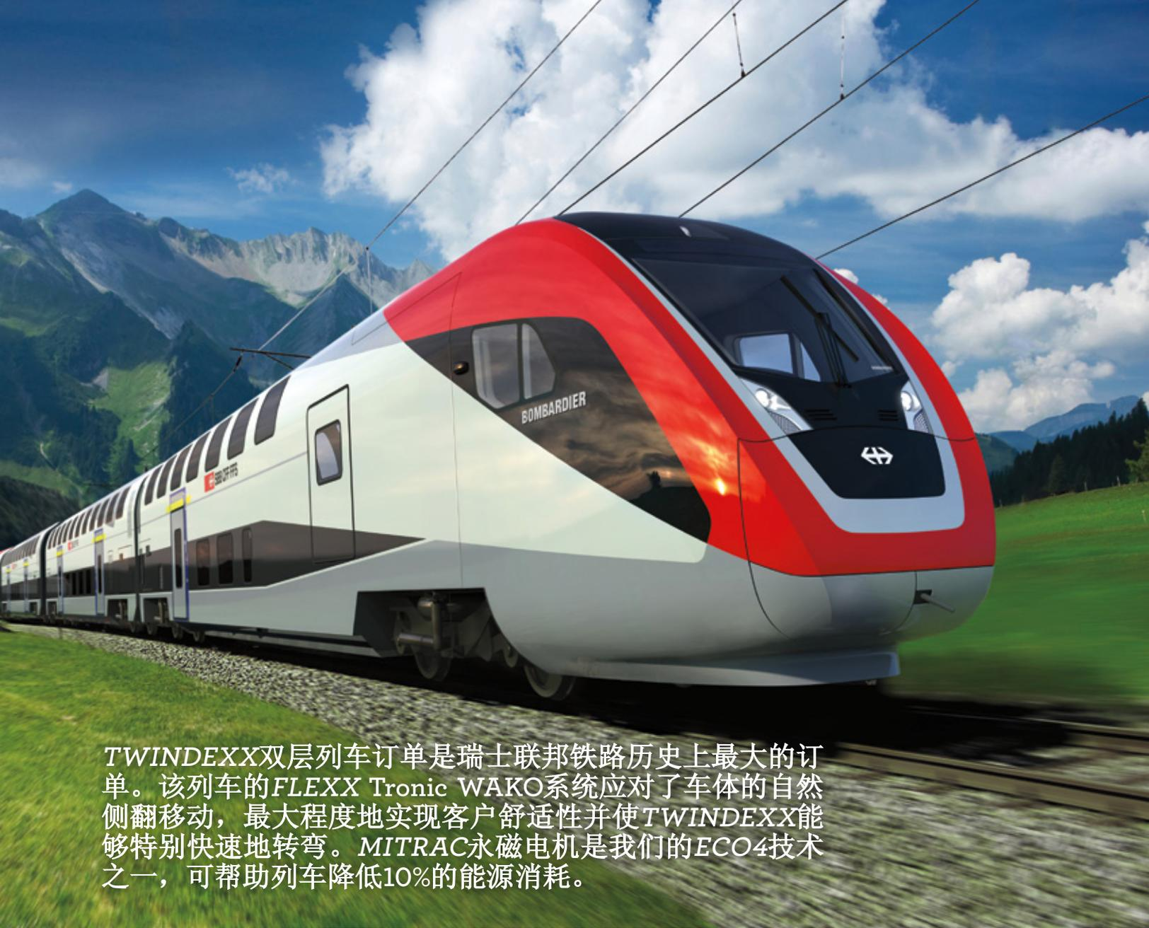
TWINDEXX双层列车订单是瑞士联邦铁路历史上最大的订单。该列车的FLEXX Tronic WAKO系统应对了车体的自然侧翻移动，最大程度地实现客户舒适性并使TWINDEXX能够特别快速地转弯。MITRAC永磁电机是我们的ECO4技术之一，可帮助列车降低10%的能源消耗。
